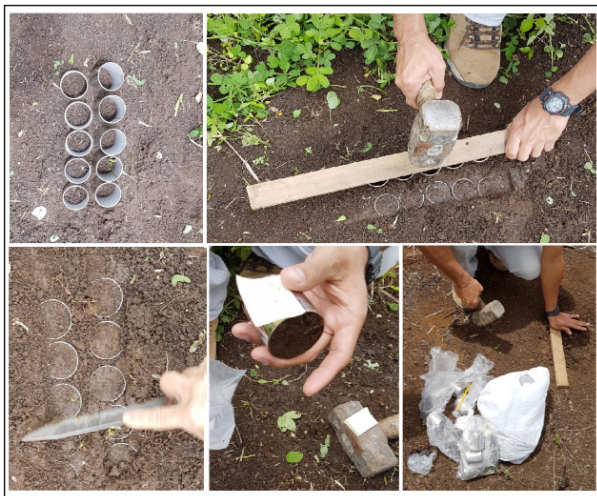
Figura 1. Procedimiento en campo para la toma de las muestras para la determinación de la Da. Cartago- Costa Rica, 2017.
