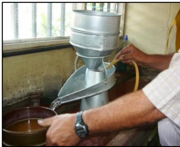
Figura. 2 (A) Fenwick modificado, (B) balón aforado de 250ml y (C) filtro para la extracción de quistes. San José, Costa Rica. 2018.
