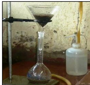
Figura. 2 (A) Fenwick modificado, (B) balón aforado de 250ml y (C) filtro para la extracción de quistes. San José, Costa Rica. 2018.
