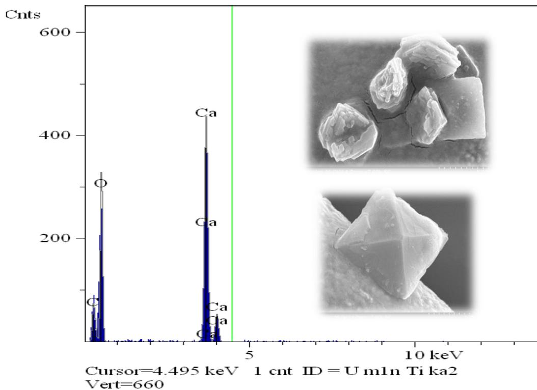
**Figura 9.** Espectograma con la emisión del pico de calcio por medio de análisis de energía dispersiva de rayos X y microfotografías de los cristales bipiramidales y amorfos por microscopía electrónica de barrido.
