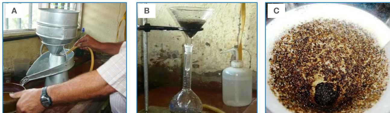
Figura. 2 (A) Fenwick modificado, (B) balón aforado de 250 ml y (C) filtro para la extracción de quistes. San José, Costa Rica. 2018.
