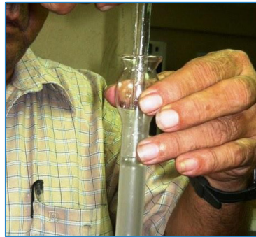
Figura 3. Homogeneizador de quistes. INTA, Costa Rica. 2005.
